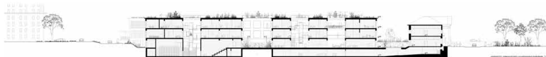
PRZĘKRÓJ A-A - POŁĄCZENIE ŁAŹNI Z PROJEKTOWANYM BUDYNKIEM
