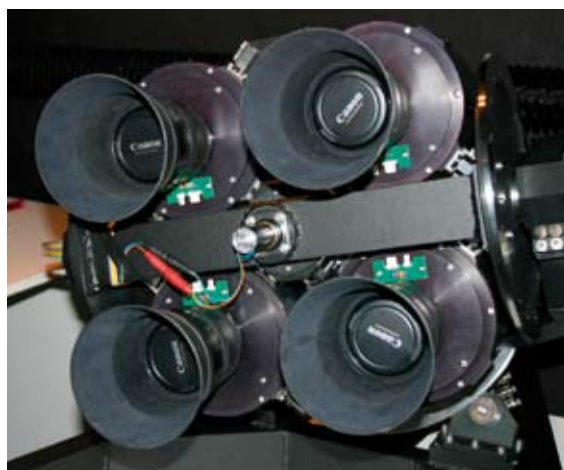
PIERWSZY MONTAŻ Z CZTEREMA KAMERAMI ZBUDOWANY DLA PEŁNEGO SYSTEMU „PI OF THE SKY”
